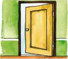
11.7. Az ajtóknak a forgástengelytől a lehető legtávolabb helyezik el a kilincset
